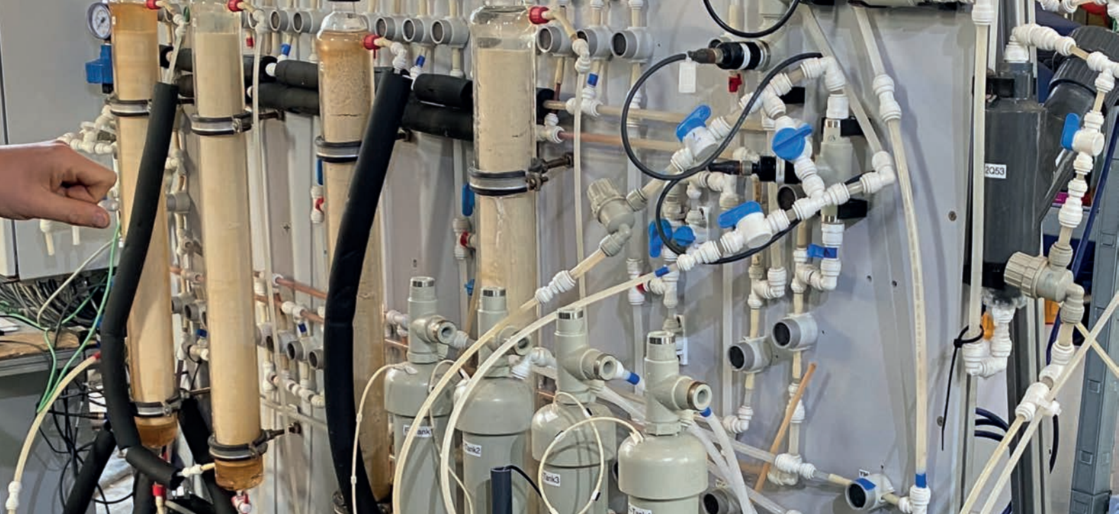
Labortests zur Gewinnung von Lithium aus Thermalwässern des Oberrheingrabens.
