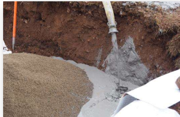
Aufschwimmversuche an Bimssand mit Flüssigbaustoff (06.04.2017)
