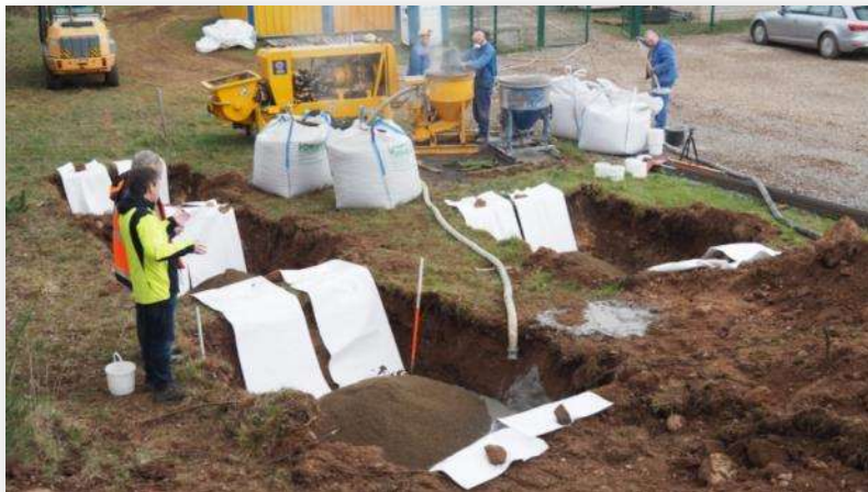
Aufschwimmversuche an Bimssand mit Flüssigbaustoff (06.04.2017)
