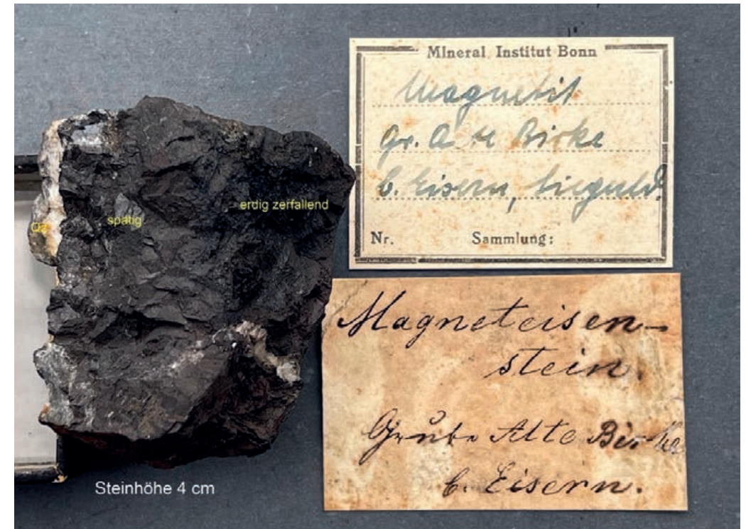
Abb. 26: Siderit-Umwandlung zu Magnetit. Grube Alte Birke (Eisern). (Foto: HG ADELMANN).
