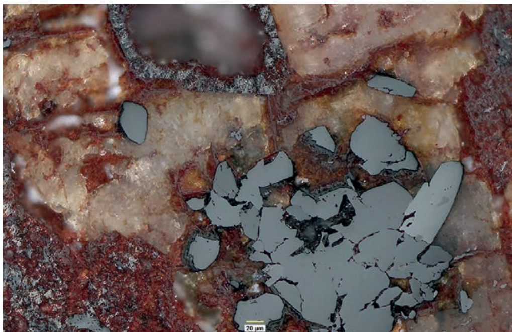
Abb. 11: Hämatit-Kristalle (grau) sprossen in Siderit. Daneben mikrokristalliner Hämatit ("Rotspat"). Grube Hohle(r)stein (Leimbachtal, Siegen).
