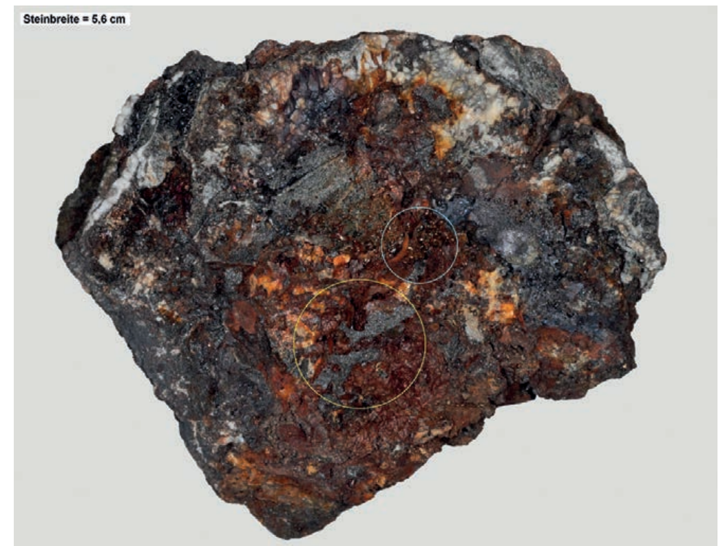
Abb. 17: Hitzealterierter Brocken mit blasigen Zonen (hellblauer Kreis) und silbrigen Erzanteilen (gelber Kreis). Grube Grüne Au, Schutzbach. (Foto: HG ADELMANN).
