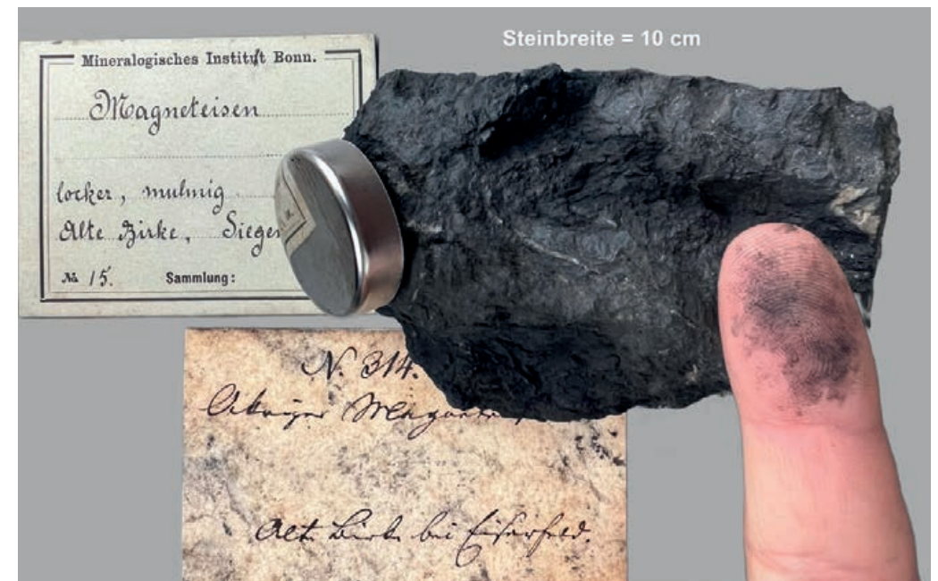
Abb. 27: Siderit-Umwandlung zu Magnetit. Grube Alte Birke (Eisern). (Foto: HG ADELMANN).
