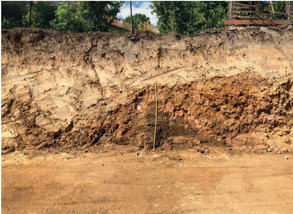
Abb. 6: Ablagerungen der t4-Terrasse (KANDLER 1970) in einer Baugrube in der Jakob-Steffan-Straße aus dem Jahr 2021. Unter einer geringmächtigen Parabraunerde liegt hellbeige-gelber Flugsand über der rötlichen t4-Terrasse, die im linken Bildbereich abtaucht. Gut erkennbar sind die zahlreichen roten Sandsteinblöcke.
