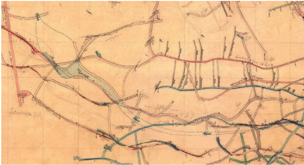
Abb. 3: Kartierung der Vulkanit-Kontakte im Grubengebäude der Grube Peterszeche (Burbach) durch Markscheider H. KLIVER von 1858 (Archiv Bezirksregierung Arnsberg).
