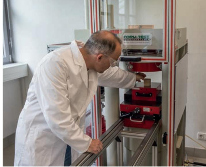
*Zu den geotechnischen Untersuchungen gehört auch der einaxiale Druckversuch. Ingo Schultheis prüft hier einen Gesteinswürfel an der Felspresse.*
