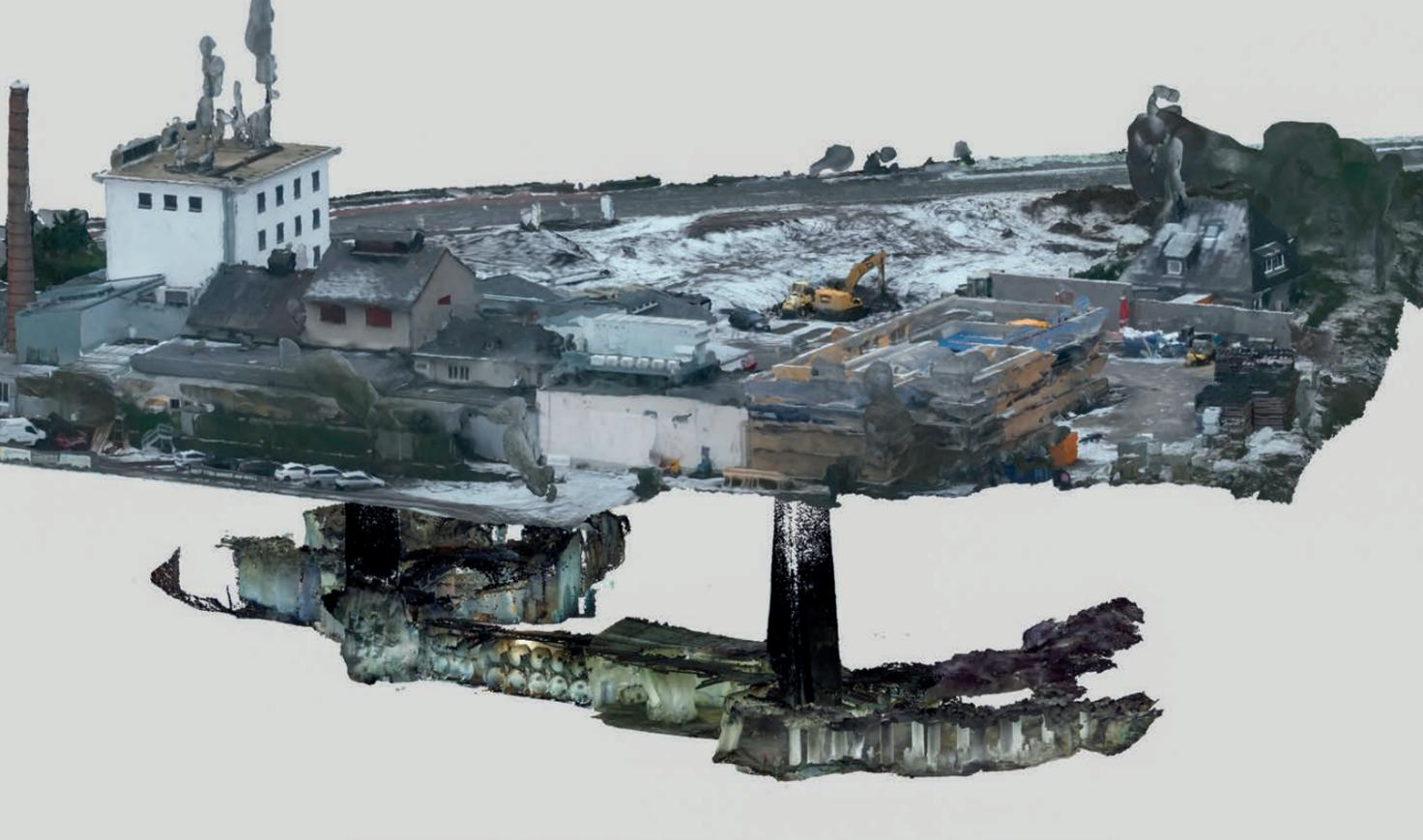
Oben: Laserscan-Vermessung der Übertage- und Untertagesituation: Das Bild zeigt das Gelände der Vulkan Brauerei. Der im Bild rechte Schacht wurde verfüllt. Darunter und rechts davon sind in den Basaltkellern einige BULLFLEX®-Pfeiler erkennbar.
