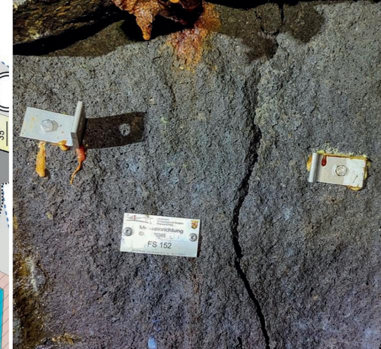
Karte der Hohlrumsituation im Bereich des Neubaus mit Anordnung der Felsspione (FS, links) und der Felsspion 152 in situ (rechts). Die BULLFLEX®-Pfeiler sind als blaue Punkte in der Karte dargestellt.
