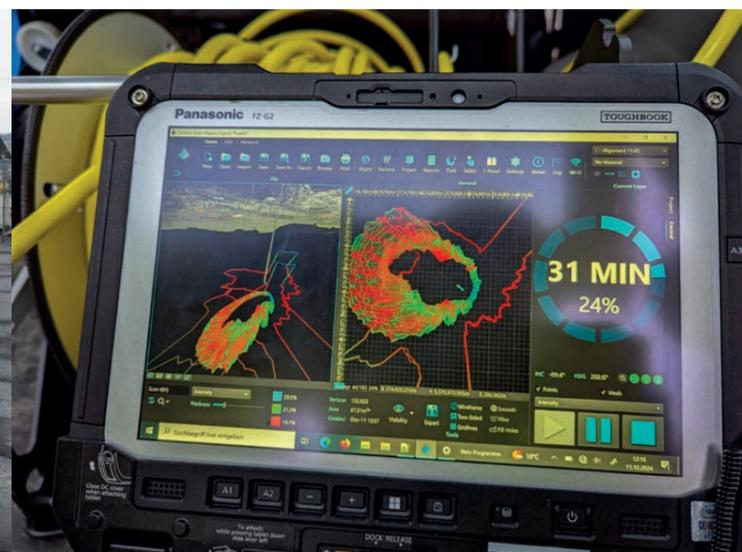
Blick auf den Kontrollmonitor während der Vermessung mit dem Hohlraum-Laserscanner („Bohrlochscanner“).
