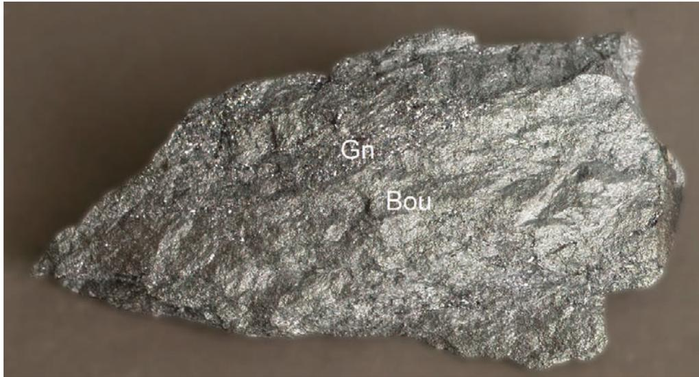
Abb. 6: Massig-faseriger Boulangerit mit eingeschaltetem Bleiglanz. 3 cm breite Probe eines 18 cm großen Reicherz-Stückes aus der mineralogischen Sammlung der Universität Bonn. Grube Stahlberg (Müsen).
