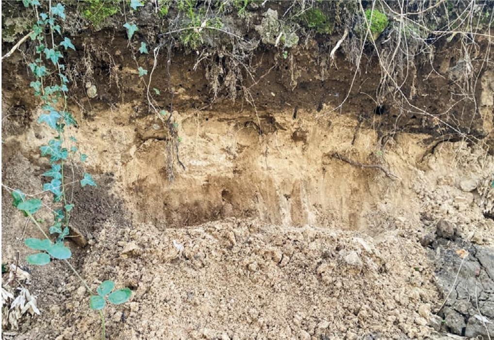
Abb. 5: Blick auf die Böschung hinter dem Haus Wallstraße 56 in der Paul-Denis-Straße. Hellgelblicher Flugsand mit leichten Verbraunungen an der Basis, an der Oberkante der Böschung rezente Mutterbodenauflage. Aufschlusshöhe ca. 50 cm.
