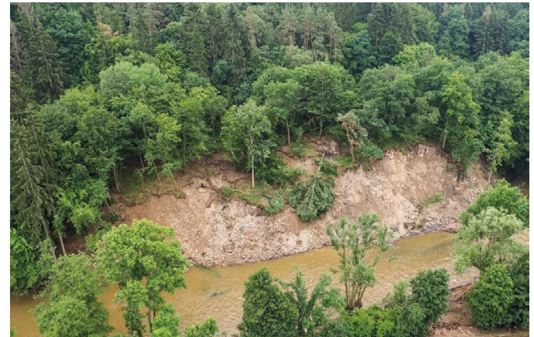
Abb. 22: Aufnahme des Fußes der Großrutschung bei Müsch mit Blickrichtung nach Südwesten auf das südliche Ufer der Ahr. Es zeigt sich der stark erodierte und teilweise nachgerutschte Rutschungsfuß im Bereich eines Prallhangs (Foto vom 17.07.2021, A. WEHINGER).
