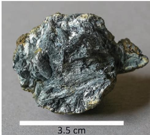
Abb. 2 (links): Typ 1 Sb-Mineralisation: „Nestartiges“ Stück Antimonerz mit Kruste aus Antimonocker aus der Gangmasse, Grube Passauf (Nuttlar). Slg. PENKERT, Foto GABI PENKERT.
