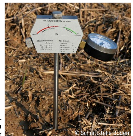
Kontrolle der Bodenfeuchte mit einem Tensiometer
