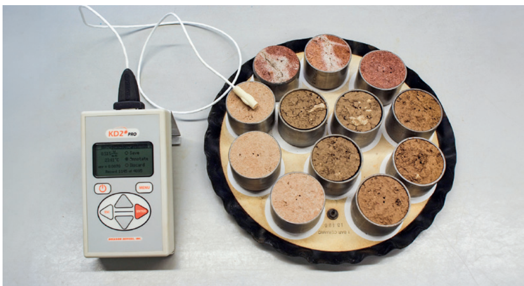
Abb. 4: Messung thermischer Parameter an Bodenstechzylindern im Bodenphysiklabor des LGB mit dem Thermal Analyzer KD 2 Pro und Doppelnadelsensor.
