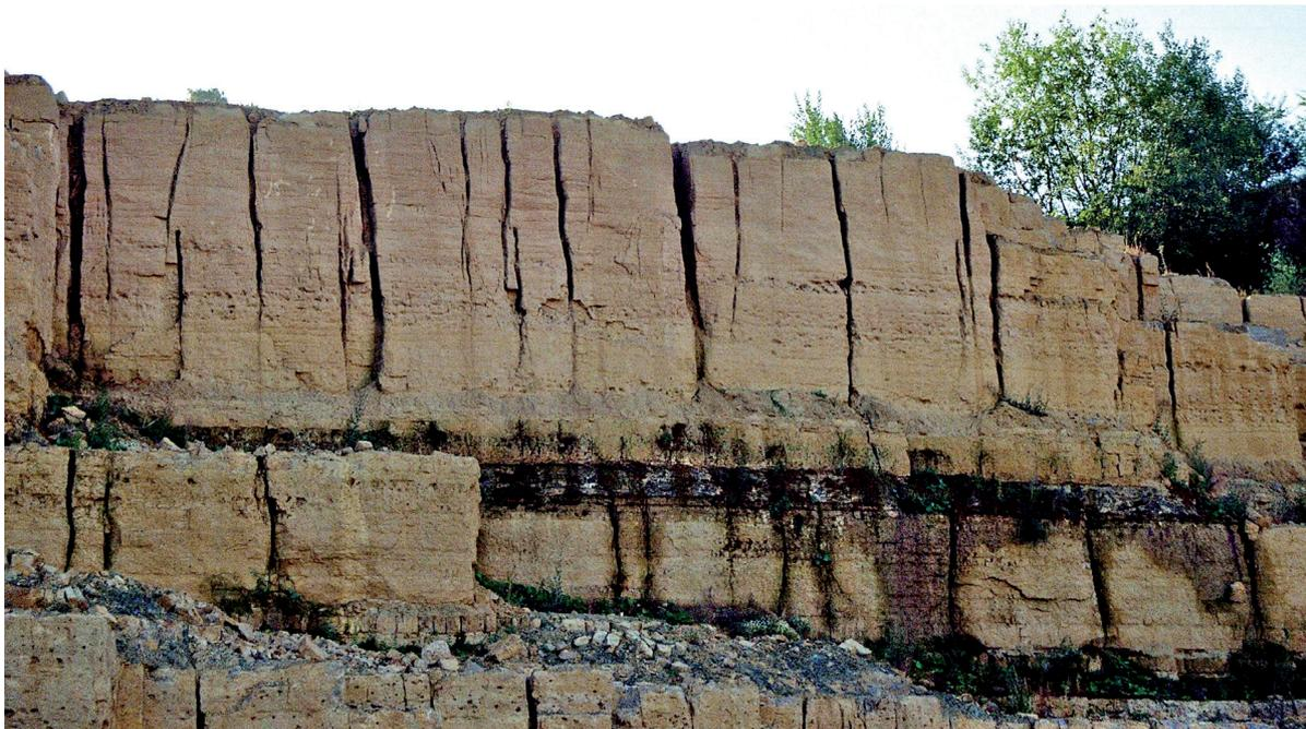
Abb. 4.4: Dolomit-Tonmergel-Wechselfolgen des Oberen Muschelkalks im Steinbruch Meckel (Foto: D. DITTRICH). Erschlossen sind hier die vergleichsweise kompakt ausgebildeten Dolomitbänke der Oberen Ceratitenschichten (mo2C2, Tab. 2.2). Die Kluftflächen in den Dolomiten sind durch tertiäre Verkarstung erweitert worden, sodass hier maximale Gebirgsdurchlässigkeiten auftreten können. In den zwischengelagerten beige-grauen oder graublauen Tonmergelpaketen setzen die Klüfte vielfach aus.
