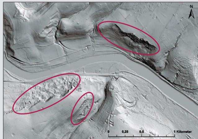
Ausschnitt eines Laserscanbildes aus der Trierer Bucht. Laserscanbilder zeigen das Relief. Mit ihrer Hilfe lassen sich unter anderem Rutschungen erkennen. Der Bildausschnitt entspricht der nebenstehenden Karte.
