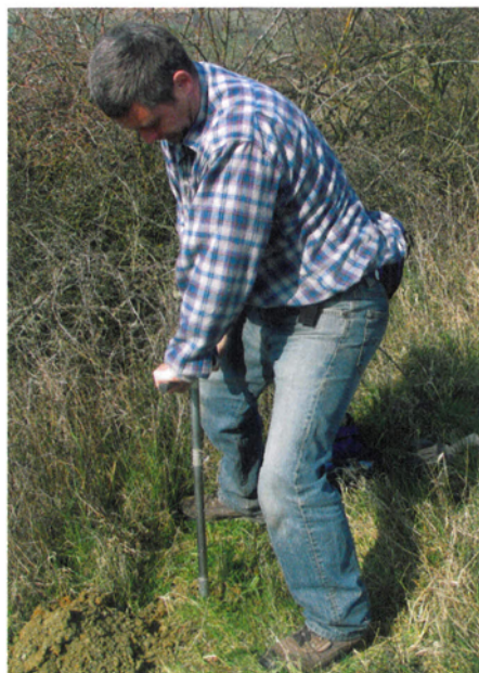
Abb.2: Aufbohren eines Versenkungsloches für die Sonde
