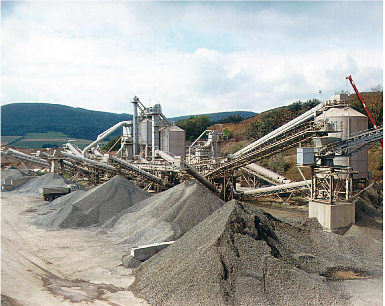
Abb. 78: Aufbereitungsanlage für „Kuselit“ (Andesit) in Pfeffelbach zur Herstellung verschiedener Körnungen.
