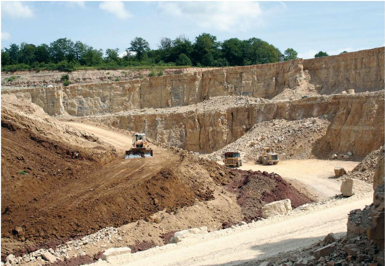
Abb. 51: Gewinnung von Kalkstein im Tagebau bei gleichzeitiger Wiederverfüllung mit Erdaushubmassen.
