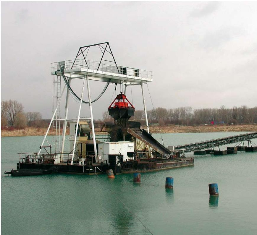
Abb. 36: Kiesgewinnung mit Schwimm-Greifbagger.
