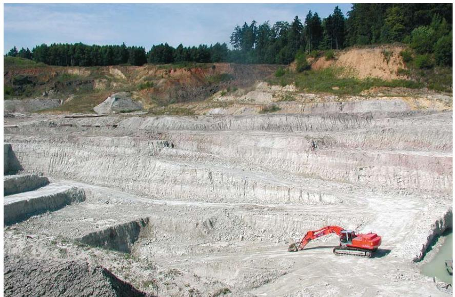
Abb. 43: Tongrube Geigenflur bei Vielbach im Westerwaldkreis. Die Gewinnung erfolgt im Tagebau mit Tieflöffelbaggern. Die Tongrube liefert vor allem hell brennende Magertone, die in verschiedensten Tonmischungen zum Einsatz kommen
