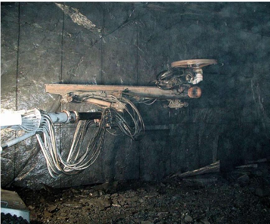
Abb. 61: Die Diamantsäge des hydraulischen Sägewagens legt vertikale und horizontale Schnitte im Dachschiefer an.
