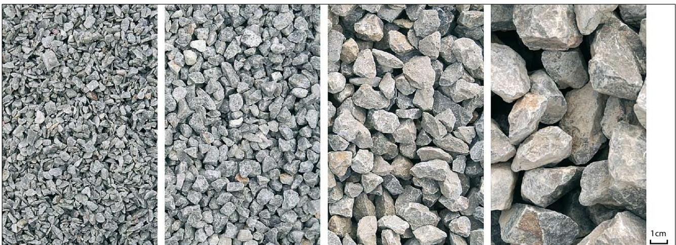
Abb. 52: Verschiedene Splittfraktionen und Schotter aus Dolomitstein aus dem Raum Bitburg-Trier.
