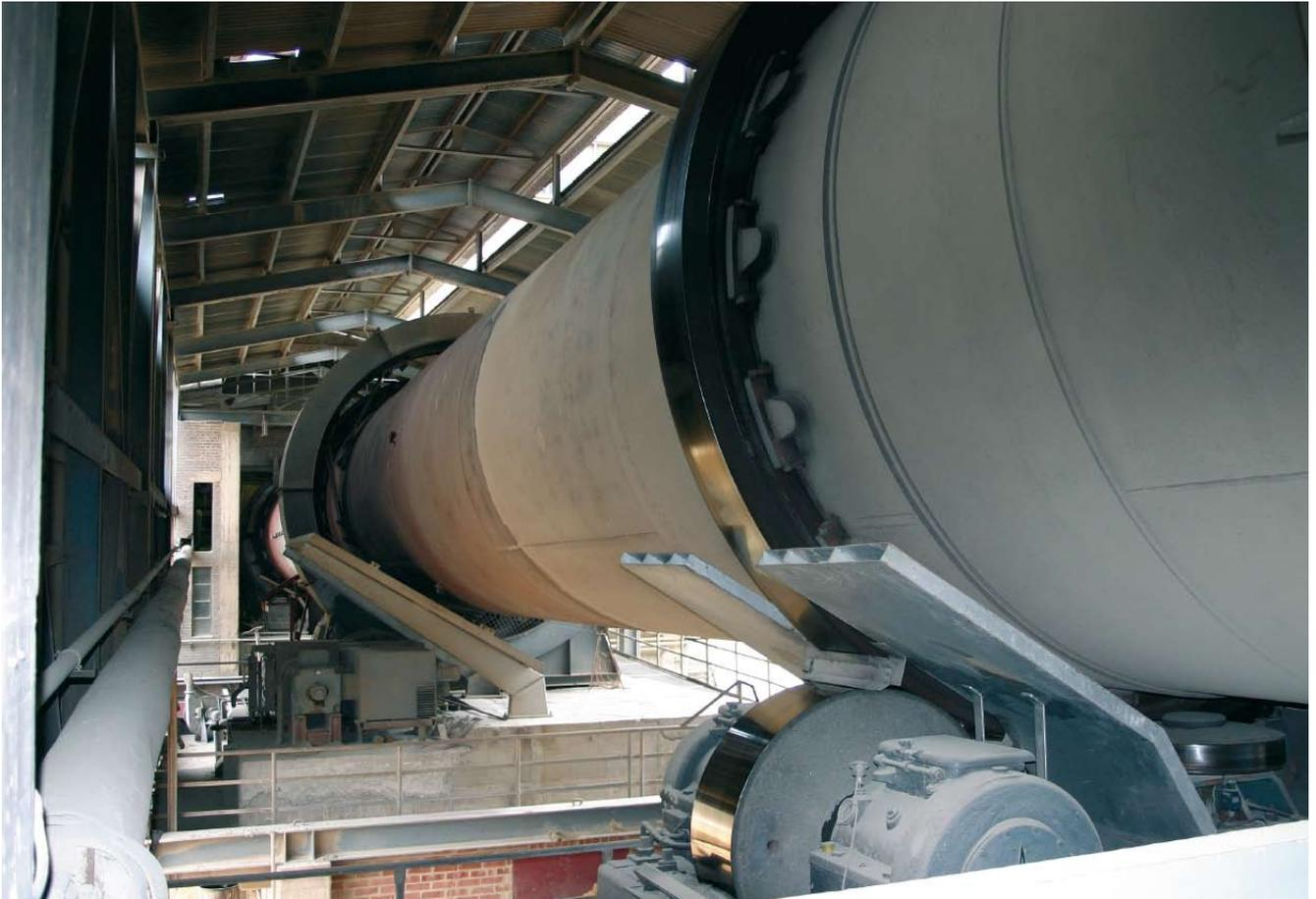
Abb. 53: Drehrohrofen im Zementwerk Wotan (Üxheim, Eifel).
