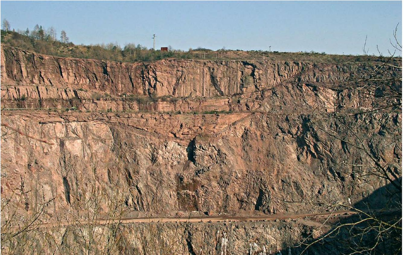
Abb. 74: Hartsteinbruch bei Albersweiler. Hier werden kambrosilurische Gneise gewonnen, die von jüngeren Laven und Sedimenten überdeckt sind.
