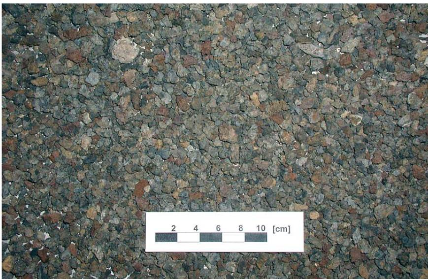
Abb. 69: Lavaschlacke-Haufwerk.
