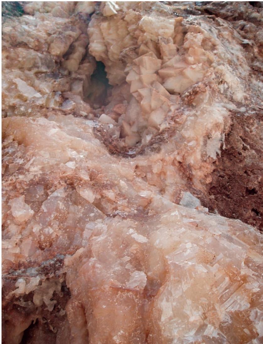
*Abb. 1: Hochreines Calciumcarbonat in Form von kristallisiertem Calcit in einem Kalksteinvorkommen (Foto SCHAEFER KALK GmbH & Co. KG).*
