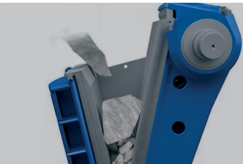
Abb. A-6: Modell eines Backenbrechers im Querschnitt. Rechts befindet sich die bewegliche, links die unbewegliche Backe (Quelle: BRECHTECHNIK | TECHNOLOGIE | KLEEMANN (WIRTGEN-GROUP.COM)).
