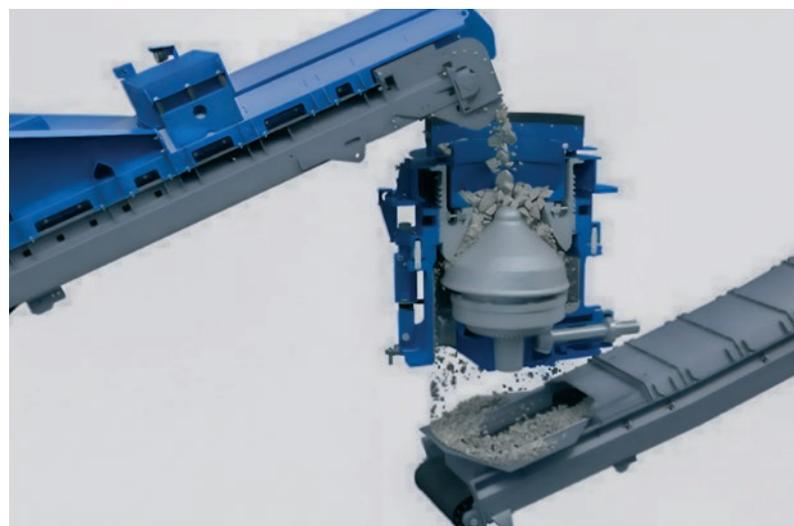
Abb. A-7: Modell eines Kegelbrechers im Querschnitt (Quelle: BRECHTECHNIK | TECHNOLOGIE | KLEEMANN (WIRTGEN-GROUP.COM)).
