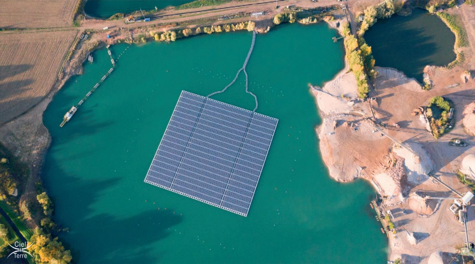
Abb. C-6: Luftbild der PV-Anlage auf dem Baggersee des Kieswerks Pfadt (Quelle: ERDGAS SÜDWEST GMBH)
