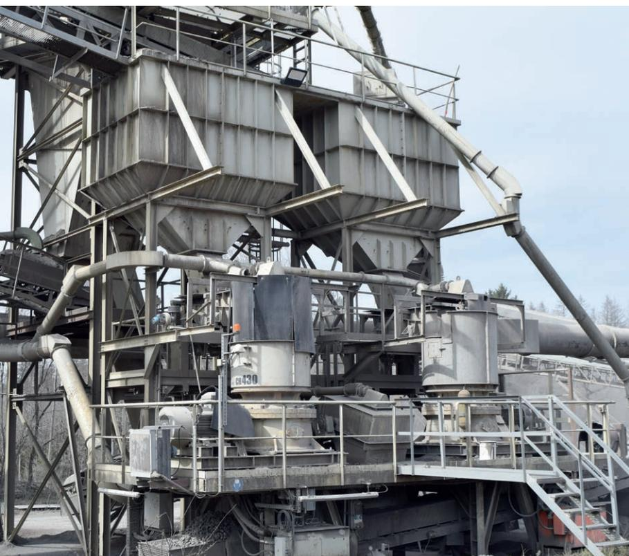
Abb. B-7: Kreiselbrecher der Edelsplittproduktion (Foto: BAG).
