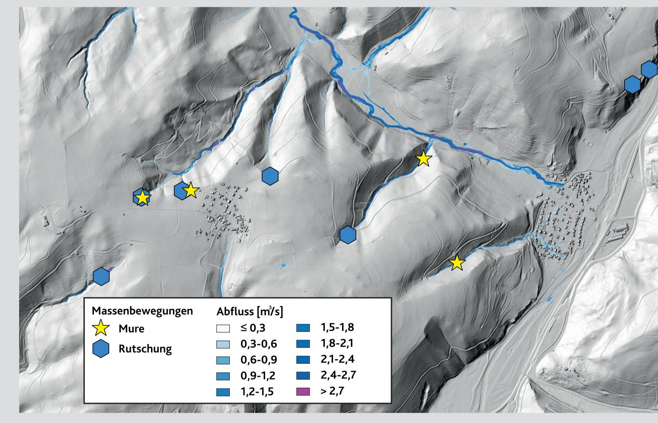
Kombinierte Darstellung der Massenbewegungen und der Modellierung des Oberflächenabflusses bei Sierscheid (unten) sowie der Modellierung der Strömungsgeschwindigkeit an Prallhängen bei Schuld (oben).
